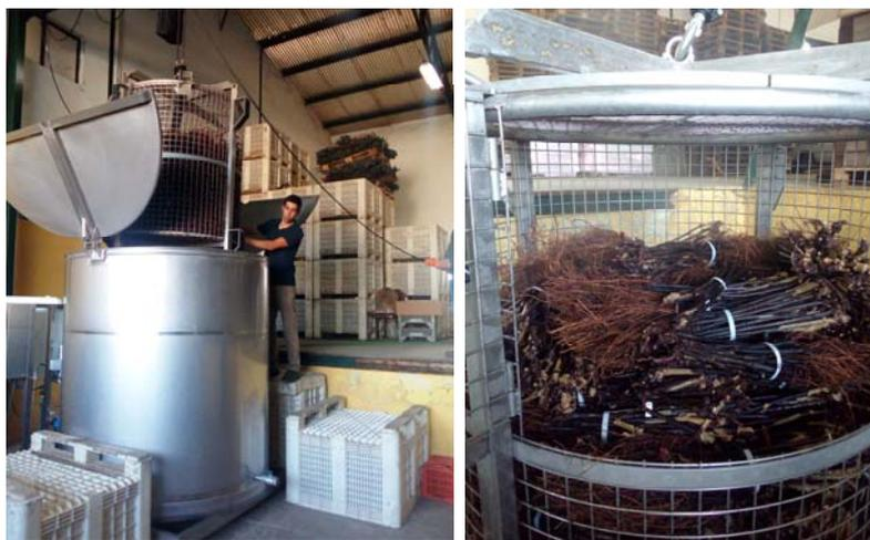
Fig. 1 - Máquina (“panela de pressão”) para proceder ao TAQ (esquerda) e cesto com material vegetativo (direita)
