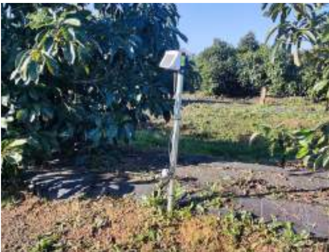
Sistema Hidrosoph para monitorização em tempo real da humidade do solo e da rega. Créditos: J. Furtado
