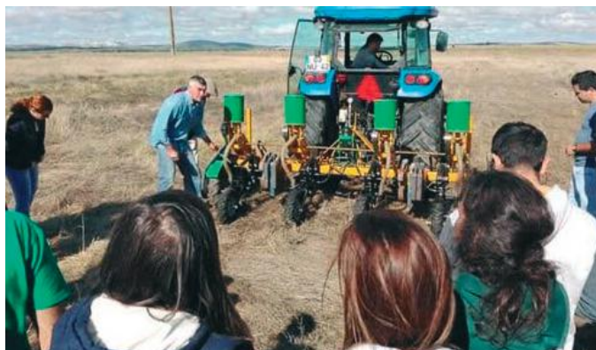
Figura – Gottlieb Basch numa sessão com alunos de apresentação do projeto ACUAsave e de um protótipo de semeador de sementeira direta de culturas de Primavera-Verão (Créditos: Gabriela Cruz/APOSOLO)
