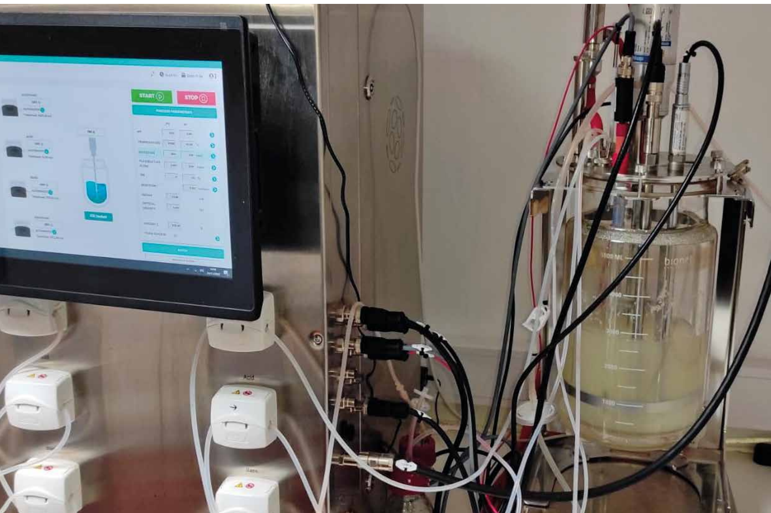
Sistemas de bioprodução de proteínas, à escala piloto e semi-industrial, para a obtenção de produtos de elevada qualidade e rendimento para a indústria cosmética.
